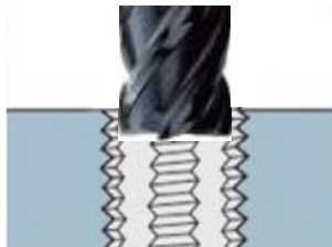
2. 折れたタップの中心にエンドミル をセットします。加工は手送りで行い 時々作業を止めて穴から切屑を取り除 いて下さい。タップ破損面を平らにし ます。
